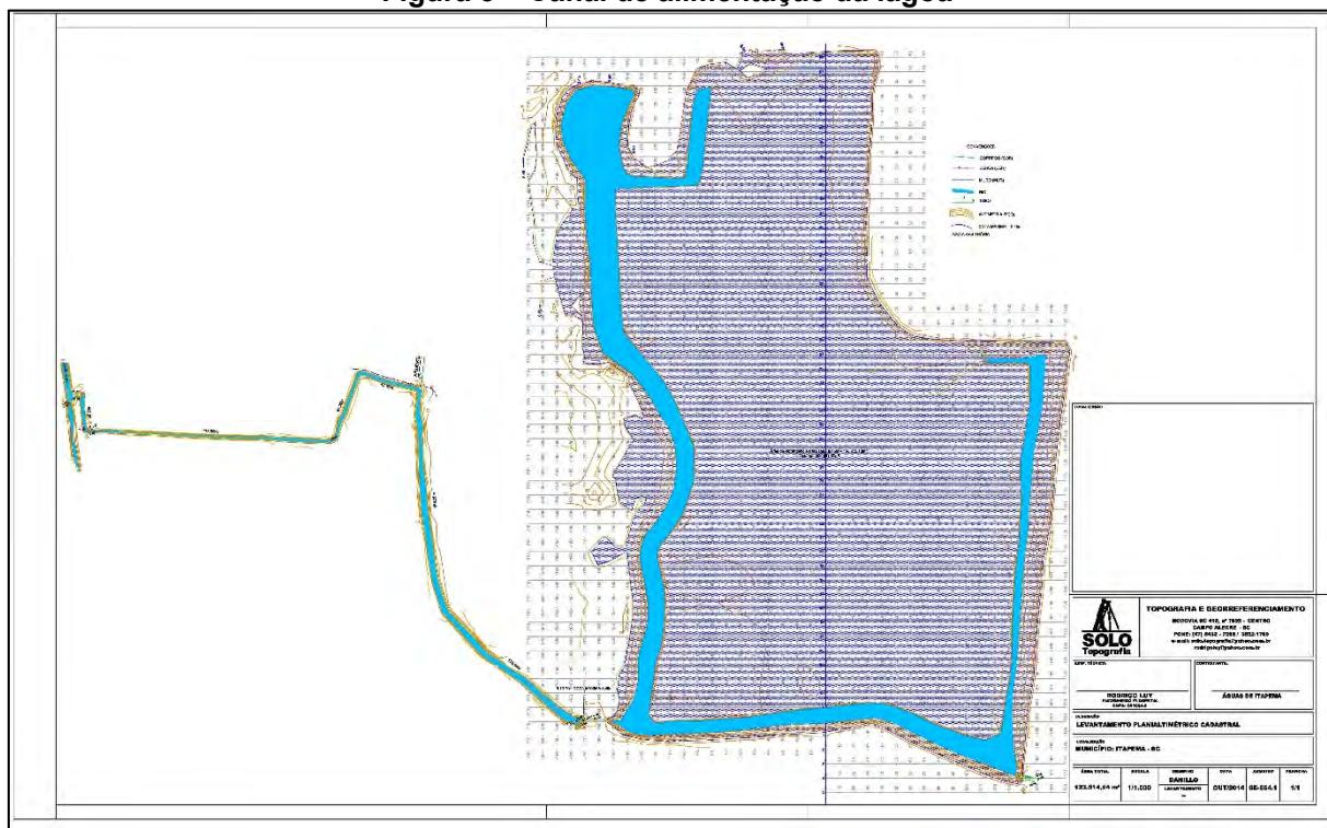
Esta captação compreende instalações eletromecânicas e uma lagoa de acúmulo com capacidade de reservação e aproximadamente 82.044m<sup>3</sup> de água bruta (Figura 4), sendo responsável pelo fornecimento de água bruta para a estação de tratamento de água Morretes, através de grupos motobomba e linha adutora de ferro fundido e PVC DEFoFo (Figura 5).
