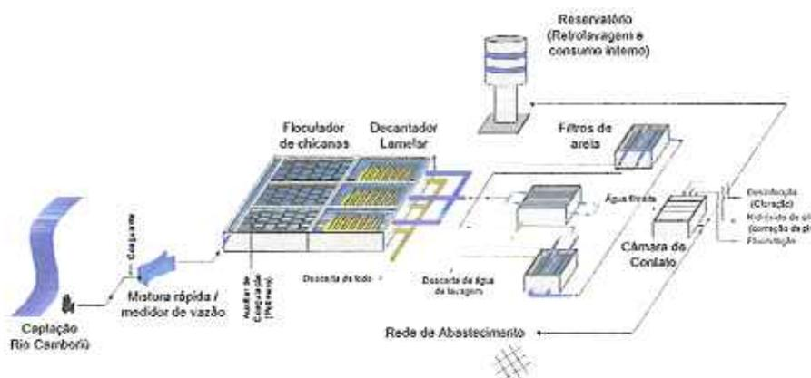
Figura 4 – Diagrama de funcionamento da ETA
