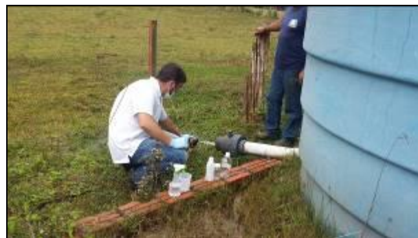
Figura 10: Coleta de amostra de água tratada nos Reservatórios interligados R2/R3, Bairro Santa Mônica.
